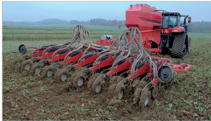
Secí stroj DTS díky pásovému zpracování pomáhá udržet vláhu v půdě a připravuje optimální strukturu půdy pro seti
