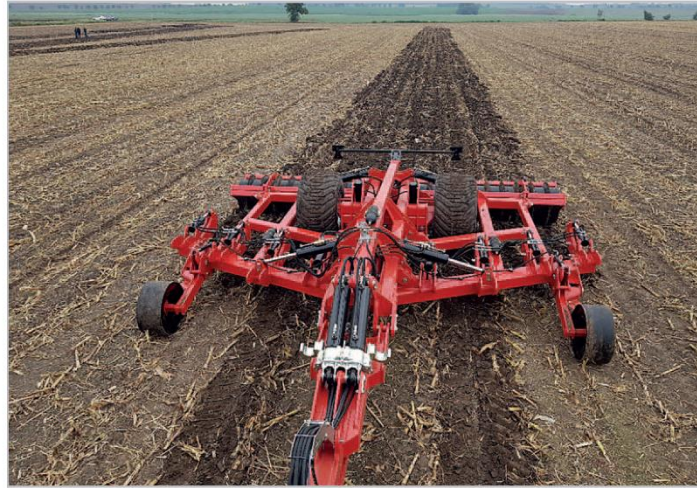
Podrývák Subsoiler v tažené verzi ozdravuje půdu a vyniká vysokou výkonností
